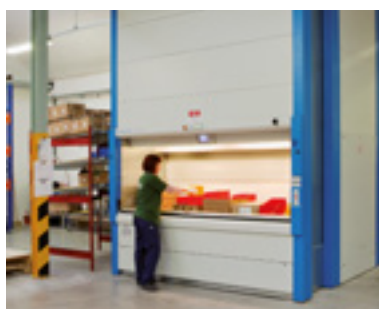
KARDEX. Veľkokapacitný automatizovaný skladovací systém.
