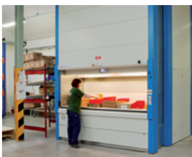
KARDEX. Veľkokapacitný automatizovaný skladovací systém.
