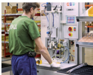
Vzduchový test na montážnej linke.
