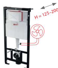
AM101/1120V Sádromodul Předstěnový instalační systém s odvětráváním pro suchou instalaci (do sádrokartonu)
