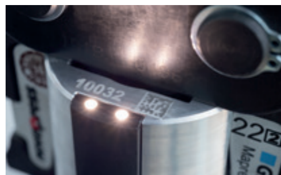
Integrované svetlo v náradí Geberit ACO/ECO 203 a ACO 203XL zaručuje dobrú viditeľnosť aj na zle osvetlených miestach.
