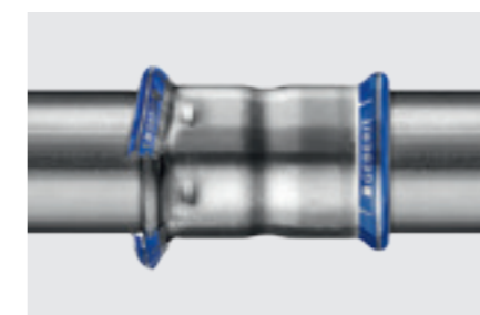
Nepoškodené farebné indikátory zalisovania identifikujú nezalisované tvarovky Mapress ešte pred zahájením tlakovej skúšky.
