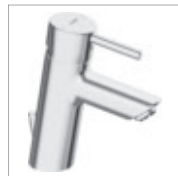
HANSAVANTIS STYLE XL Jednootvorová páková baterie pro umyvadlo, DN 15 pro beztlaké ohřivače vody 5238 1177 chrom # Pin - tyčinková ovládací páka, odpadní souprava (kov), připojení měděné trubičky vyložení: 110 mm
