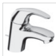
HANSAPICO Jednootvorová páková baterie pro umyvadlo, DN 15 4604 2203 chrom odpadní souprava (kov), připojení tlakové hadice G 3/8 vyložení: 102 mm
