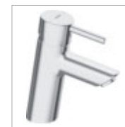
HANSAVANTIS STYLE XL Jednootvorová páková baterie pro umyvadlo, DN 15 5237 2277 chrom Pin - tyčinková ovládací páka, bez odpadní soupravy, připojení tlakové hadice G 3/8 vyložení: 110 mm
