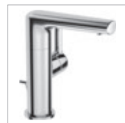
HANSARONDA Jednotvorová páková baterie pro umyvadlo, DN 15 5526 2203 chrom otočný výtok, odpadní souprava (kov), připojení tlakové hadice G 3/8 vyložení: 115 mm
