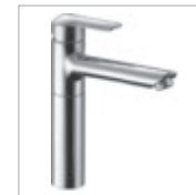
HANSAVANTIS Jednootvorová páková baterie pro umyvadlo, DN 15 se zvýšeným podstavcem 5247 2203 chrom připojení tlakové hadice G 3/8 vyložení: 216 mm
