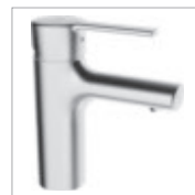
HANSARONDA Jednotvorová páková baterie pro umyvadlo, DN 15 0308 2273 chrom bez odpadní soupravy, připojení tlakové hadice G 3/8 vyložení: 100 mm
